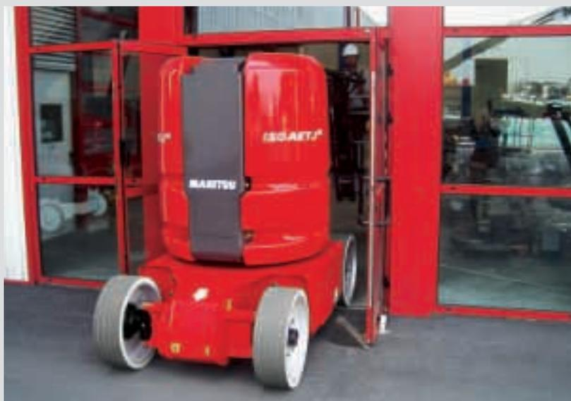
◆ Con un ingombro inferiore a 2 metri, gli AETJ entrano facilmente negli edifici dotati di porte standard.
